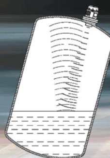
Установка датчика под углом к отражающей поверхности без успокоительной трубы.
